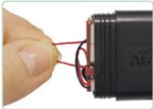
Для замены батарейного блока отключите разъём от платы устройства. Потяните петлю и извлеките блок батарей. Вставьте новый батарейный блок, подключите разъём.
